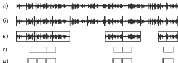
Рис. 2. Этапы обработки речи на стороне источника (а) оцифрованный поток, (б) после разбиения на блоки, (в) поток, прошедший VAD т.е. без пауз, (г) сжатый поток, (д) поток RTP пакетов (по одному блоку на пакет)
