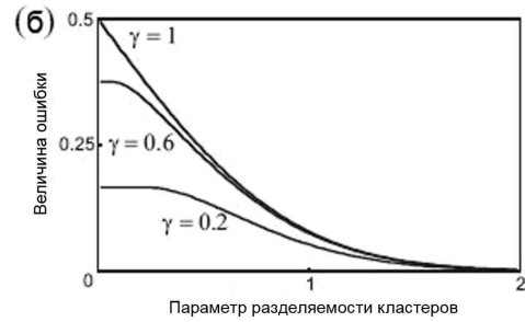
Рис. 3. (а) Пример распределения вейвлет-коэффициентов W_i для набора зашумленных спайков двух нейронов. Пунктирные линии обозначают распределения для одиночных нейронов, (б) Минимальная величина ошибки как функция параметра разделения кластеров для нескольких значений отношения количества спайков генерируемых нейронами \gamma .
