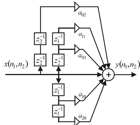
Рис. 1. Структурная схема двумерной нерекурсивной цифровой системы второго порядка с симметричными коэффициентами.
