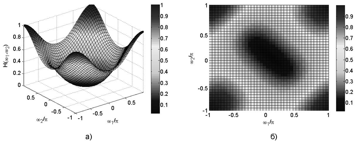
Рис. 3. Типичный вид АЧХ двумерного цифрового фильтра верхних частот
