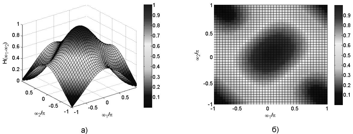
Рис. 2. Типичный вид АЧХ двумерного цифрового фильтра нижних частот
