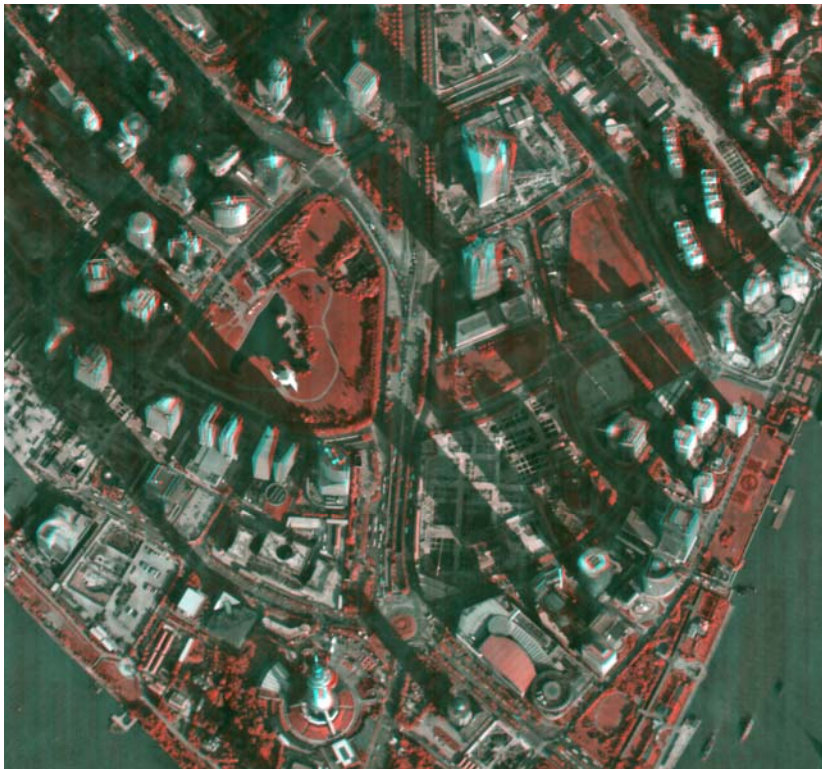
Рис. 1. Анаглифическое стереоизображение, полученное на основе данных от первого и третьего ОЭП КА «Ресурс-ДК» (для просмотра необходимы анаглифические очки)
