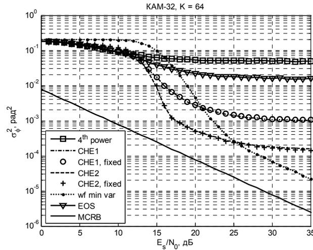
Рис. 1. Зависимость дисперсии оценки фазового сдвига от отношения сигнал/шум на символ для созвездия КАМ-32
