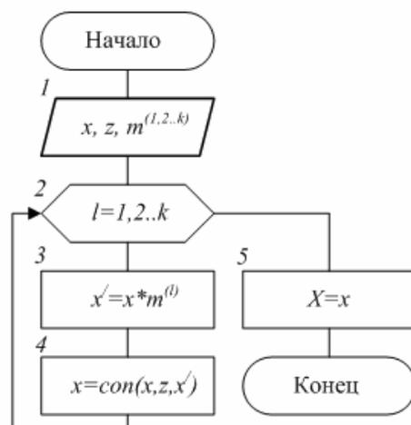
Рис. 1. Алгоритм построения последовательности с ZCZ ААКФ
