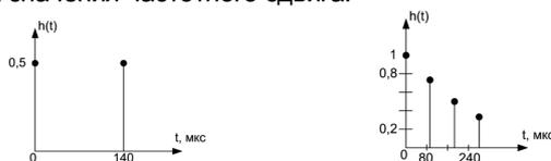
Рис. 3. а) двухлучевая модель; б) экспоненциальная модель
