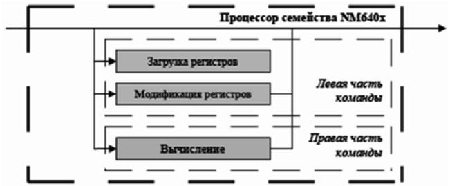
Рис. 3. Выполнение скалярной команды процессора, представленное в виде параллельной системы
