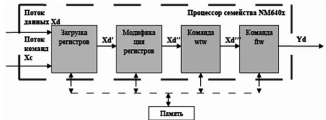
Рис. 4. Детализированная схема выполнения левой части векторной команды
