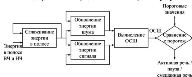
Рис. 7. Алгоритм RDA кодера IS-127
