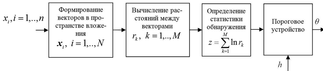
Рис. 1. Функциональная схема фрактального обнаружителя радиосигналов
