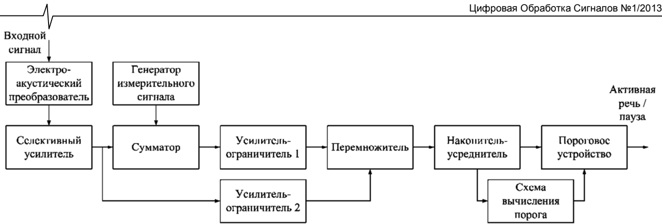
Рис. 11. Структурная схема детектора активности речи
