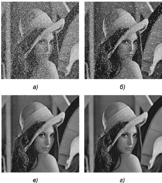
Рис. 5. Результаты обработки цветного изображения при наличии импульсных помех в каждом канале: а – искаженное импульсными помехами изображение, б – результат пространственно-избирательного медианного восстановления [4], в – результат градиентной реконструкции, г – результат пространственно-избирательного медианного восстановления [4] после градиентной реконструкции
