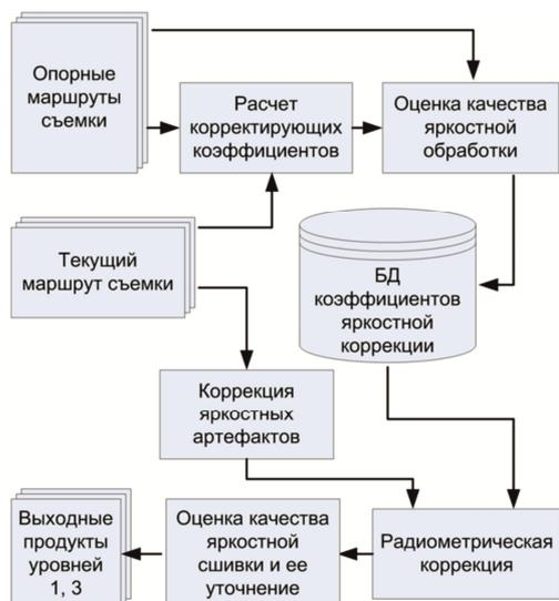
Рис. 5. Схема радиометрического обеспечения данных «Канопус-В» и «БКА»
