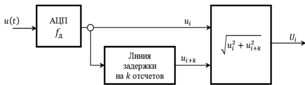
Рис. 4. Функциональная схема цифрового способа выделения огибающей
