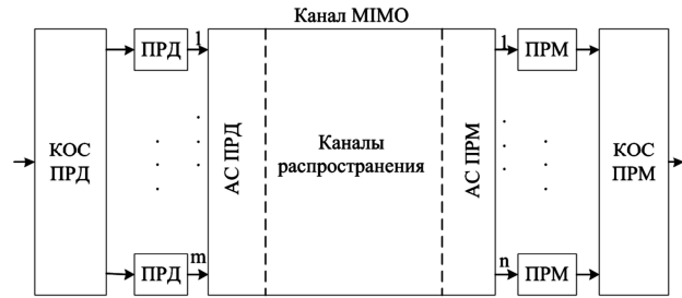
Рис. 1. Укрупненная схема фрагмента радиолинии с MIMO
