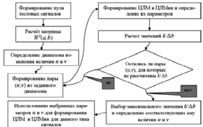
Рис. 2. Схема выбора параметров u и \nu для расчета ЦПМ и ЦПМин
