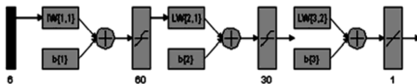
Рис 2. Архитектура нейронной сети по аппроксимации данных КЛ станции «Апатиты»
