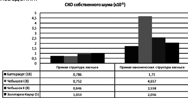
Рис. 12. СКО собственного шума БИХ-фильтров с прямой и прямой канонической структурой звеньев
