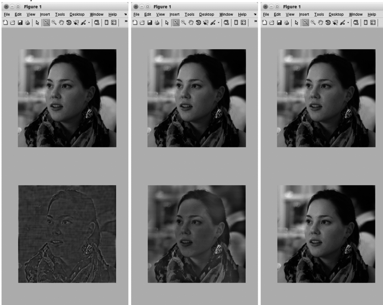
Рис. 1. Результаты моделирования тракта видеобработки в MATLAB при различных разрядностях коэффициентов преобразования Фурье; верхний ряд – эталонное изображение, нижний ряд — результат обработки при помощи IP-ядра;
