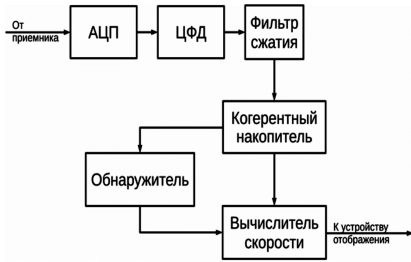
Рис. 1. Общая функциональная схема тракта цифровой обработки РЛС
