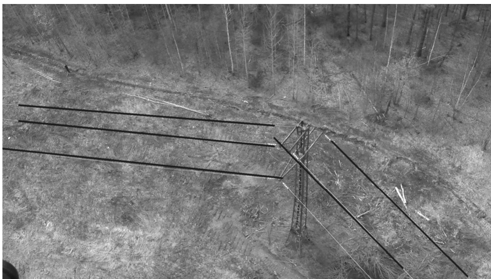
Рис. 4. Результат обработки одного из кадров алгоритмом обнаружения ЛЭП (тёмными линиями обозначены обнаруженные провода)
