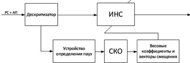
Рис. 3. Структурная схема нейросетевой реализации алгоритма подавления АП
