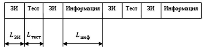
Рис. 1. Структура сигнала с ЗИ
