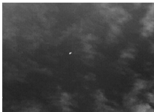
Рис. 2. Результат применения операции свёртки при обработке изображения БЛА на фоне кучевой облачности
