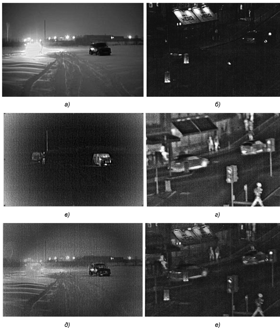
Рис. 3. Пример комплексирования ТВ изображений – а, б и ТПВ изображений – в, г по известным алгоритмам [5, 6] – д, е
