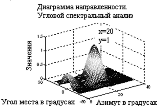
Рис. 4. Двумерная суммарная диаграмма направленности, полученная методом углового спектрального анализа
