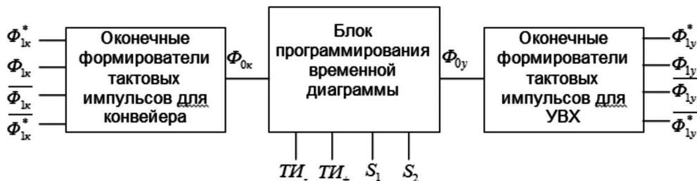
Рис. 10. Блок-схема формирования тактовых импульсов: TI_+, TI_- – входные тактовые импульсы;
