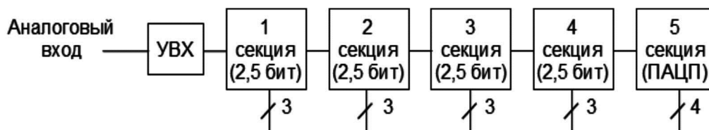
Рис. 2. Блок-схема одного канала 12-разрядного АЦП: ПАЦП – параллельный (flash) АЦП
