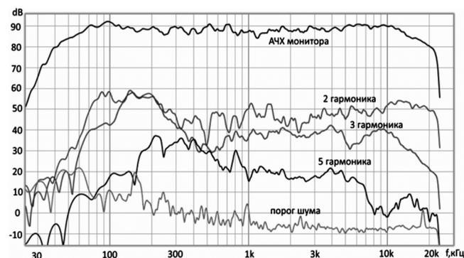
Рис. 6. АЧХ и частотные характеристики нелинейностей 2, 3 и 5-го порядков студийного монитора.
