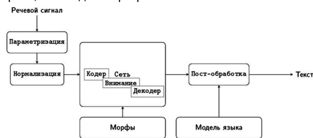
Рис. 2. Схема сквозной системы распознавания речи (encoder-decoder)
