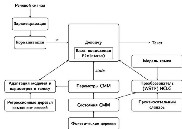
Рис. 1. Схема гибридной DNN-HMM архитектуры системы распознавания речи
