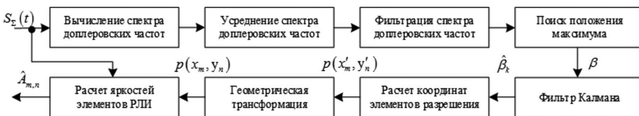
Рис. 5. Последовательность действий при реализации алгоритма формирования РЛИ с компенсацией по углу сноса
