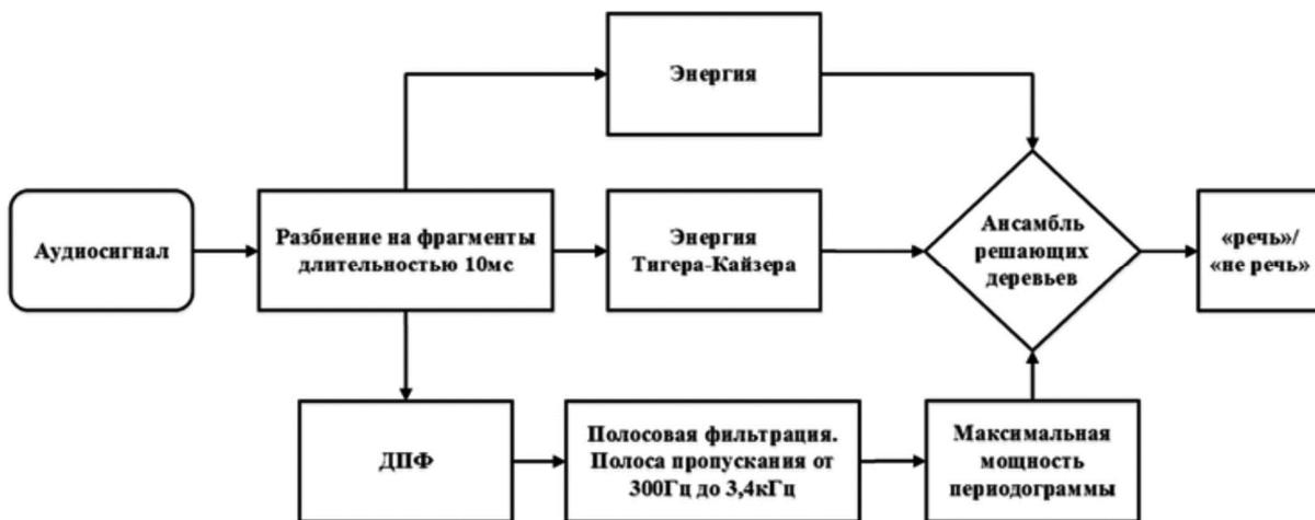
Рис. 1. Структурная схема предложенного алгоритма КДГА
