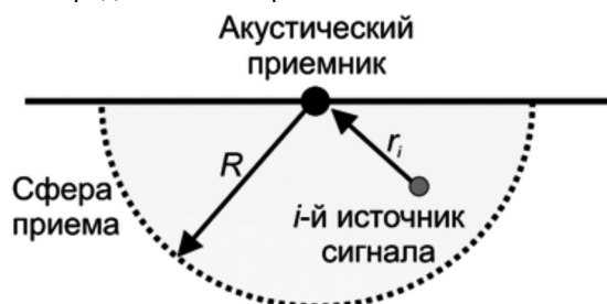
Рис. 1. Схема приема сигнала геоакустической эмиссии в пункте наблюдений «Карымшина»
