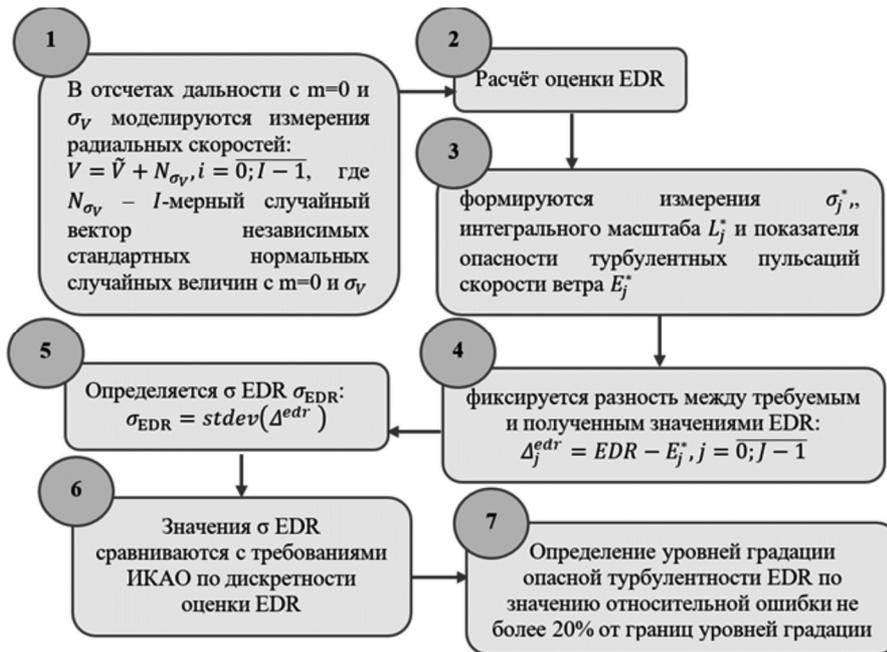
Рис. 4. Этапы цикла по независимым испытаниям
