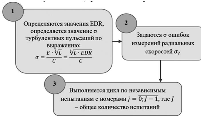
Рис. 3. Этапы реализации определения характеристик точности оценки параметров турбулентности EDR методом статистических испытаний «Монте-Карло»
