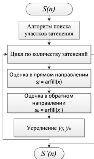
Рис. 1. Блок-схема алгоритма восстановления сигнала на основе АР-модели
