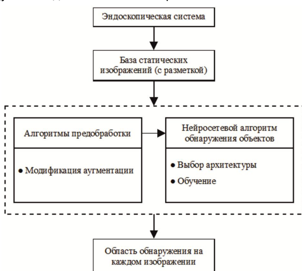
Рис. 1. Обобщенная структурная схема разработки нейросетевого алгоритма обнаружения полипов кишечника
