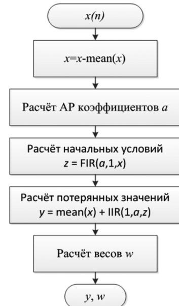
Рис. 2. Блок-схема функции arfill
