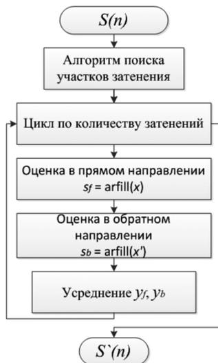
Рис. 1. Блок-схема алгоритма восстановления сигнала на основе АР-модели
