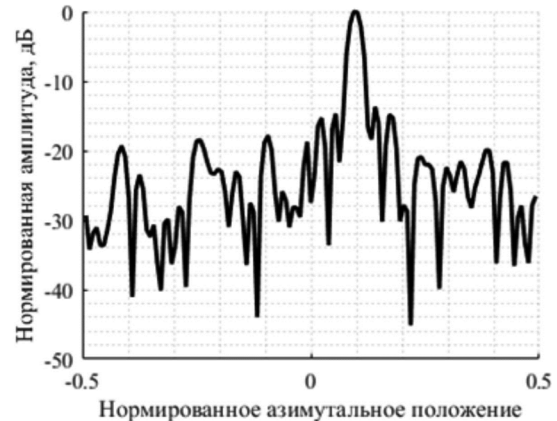
Рис. 12. Пространственное распределение в азимутальной плоскости для дальности 500 м
