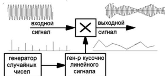
Рис. 12. Структура блока амплитудной модуляции в составе свёрточного ревербератора
