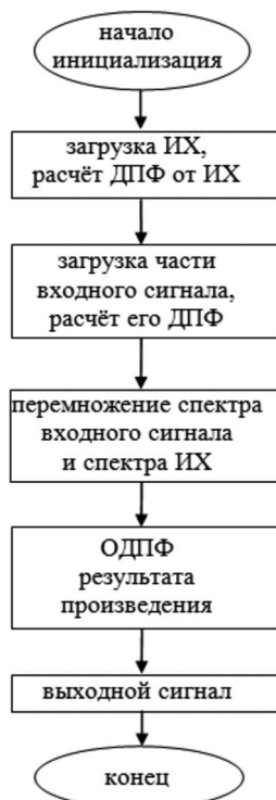
Рис. 9. Структура алгоритма свёрточного ревербератора с традиционной свёрткой
