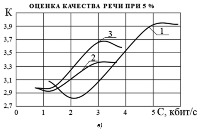
Рис. 5. Зависимости качества восстановленной речи от скорости передачи при различной вероятности ошибок в канале связи
