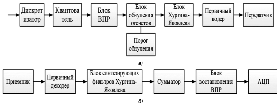
Рис. 1. Структурная схема кодера (а) и декодера (б) на основе ВПР и модификации алгоритма Хургина-Яковлева
