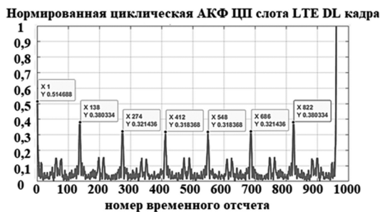
Рисунок 3. Модуль нормализованной циклической АКФ ЦП 7 символов OFDM слота кадра LTE
