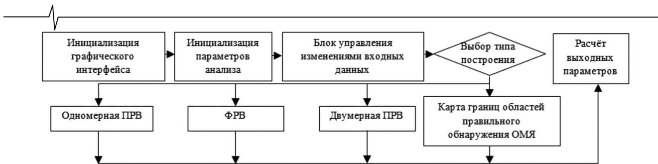
Рисунок 4 – Структурно-логическая схема программной части ПАМ
