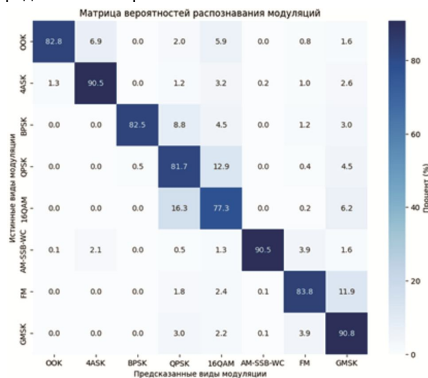
Рисунок 4 – Матрица ошибок распознавания на наборе данных RadioML2018.01A с аугментацией данных
